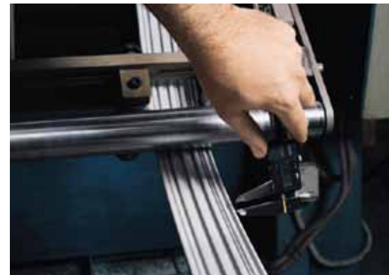
Qualitätskontrolle während des Profilextrusionsvorgangs
